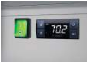
Termostato digitale e interruttore di funzionamento luminoso
